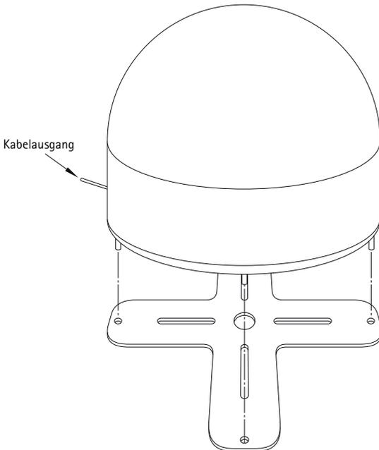
Bitte montieren Sie die automatisch nachführende Satelliten-Empfangsanlage an geeigneter Stelle.
